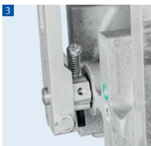
Tope terminal con tornillo de ajuste para la velocidad en vacío
