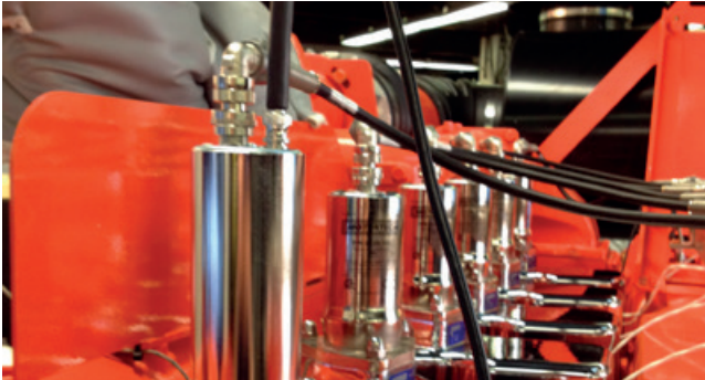
*Высоковольтные катушки MOTORTECH с монтажным фланцем и с разъемом диагностики
