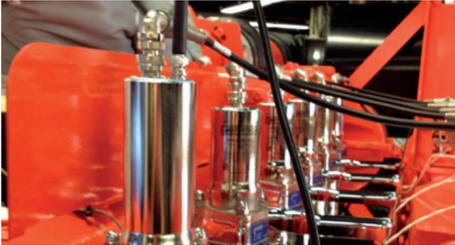
\* MOTORTECH Flanschzündspule mit Diagnoseschnittstelle
