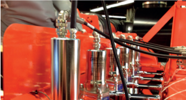
* Bobina flange MOTORTECH con un interfaz para diagnósticos
