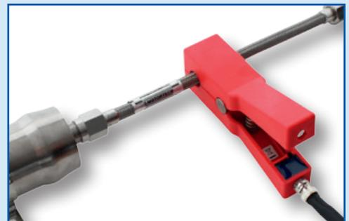
应用在常规金属屏蔽式高压导线上
