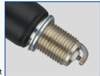
Zündkerzen mit einem neuen Dichtring montiert werden, um im weiteren Betrieb wieder eine bestmögliche Abdichtung zu erreichen.
