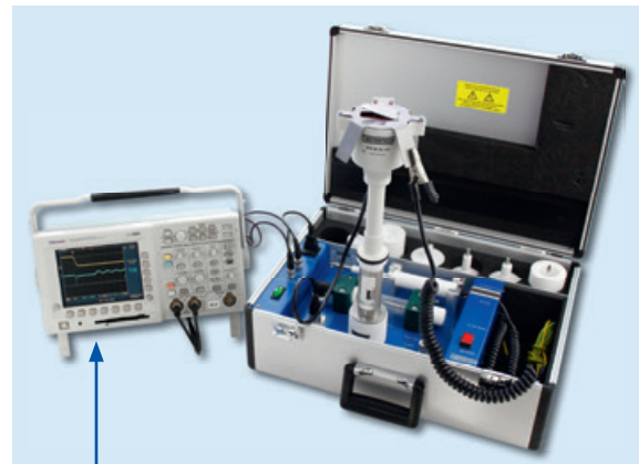
Betrieb mit Testadapter für CATERPILLAR®-Zündspulen
