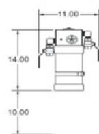
Minimalabstand zum Austausch der Filterelemente bei Objektmontage.
