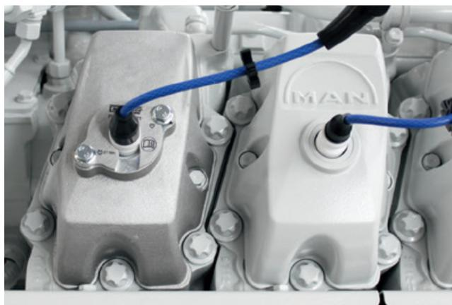
Für die von MAN® empfohlene Nachrüstung bereits im Feld in Betrieb genommener Motoren ohne Sicherung bietet MOTORTECH einen geeigneten Ventildeckelumrüstungsatz, der alle Komponenten für eine einfache Umrüstung enthält:
