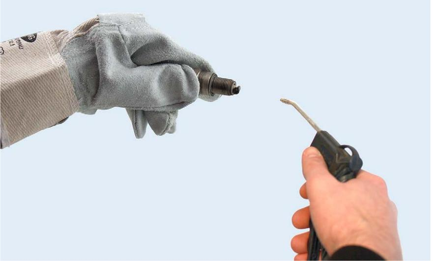
8. Wiederholen Sie bei Bedarf den Reinigungsvorgang ab Schritt 3 bis die Zündkerze rückstandsfrei ist.
