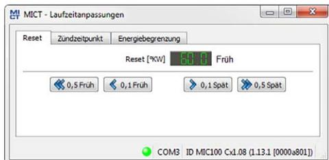
Die Index-/Reset-Position kann während des Betriebs des Gerätes um 5 °KW (Früh/Spät) korrigiert werden. Die Korrektur erfolgt über die Tasten:
