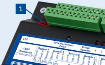
Wenn nicht alle Zylinder mit Klopfensoren ausgestattet werden, wird der Zündimpulsensor entsprechend an dem Zylinder montiert, an dem der erste Klopfensensor montiert ist.
