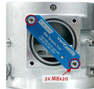
5. Spannen Sie den Antriebsriemen fest, indem Sie die Adapterplatte so weit wie möglich nach oben ziehen und halten.
