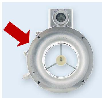
2. Legen Sie diesen Gaseinlass frei, indem Sie die Abdeckung oder den Flansch entfernen.
