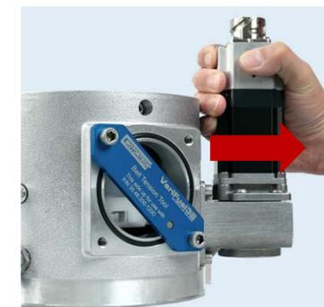
6. Während Sie die Adapterplatte in dieser Position halten, fixieren Sie die Schrauben der Adapterplatte mit einem Anzugsmoment von 10 Nm (7,4 lb-ft).
