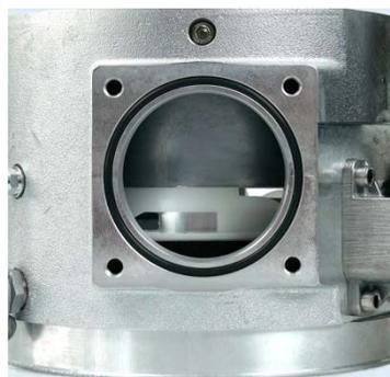
3. Entspannen Sie den Riemen, indem Sie die Schrauben der Adapterplatte so weit lösen, dass die Schrauben eingedreht bleiben, Sie aber die Adapterplatte bewegen können.
