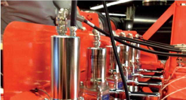
* Bobine à bride avec Interface de diagnostic MOTORTECH (connecteur BNC)
