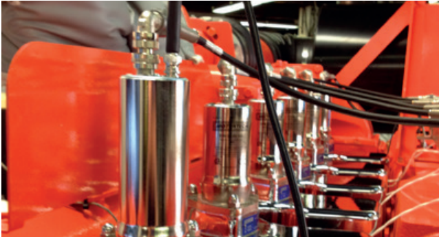
* MOTORTECH Flanschzündspule mit Diagnoseschnittstelle
