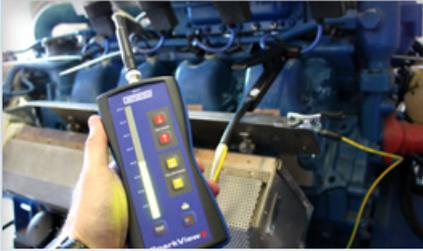
El nuevo dispositivo portátil sirve para supervisar la necesidad de alta tensión de las bujías durante el funcionamiento. Mediante la tenaza o el cable de medición y la visualización de hasta 40 kV se puede comprobar sin problema alguno el estado de las bujías y determinar el momento óptimo para cambiarlas.
