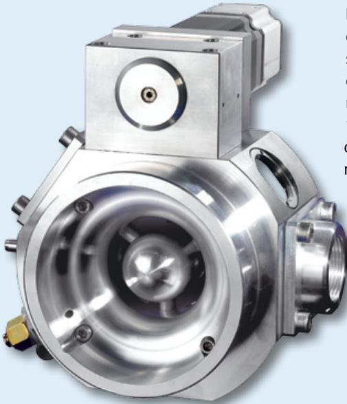
El VariFuel2 es un mezclador variable de gas Venturi de alta tecnología que se adapta continuamente a los cambios del carburante y permite al motor maximizar su eficiencia. Las series 100, 140, 200 y 250 están disponibles para casi todos los motores. Acoplado a un regulador lambda (pobre o estequiométrico) regula la mezcla con precisión. Se emplea mucho en aplicaciones de biogás, en las que el valor calorífico del carburante puede cambiar constantemente.
