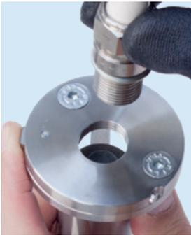
**3** Встроенный быстродействующий затвор обеспечивает быструю замену и надежную фиксацию свечей зажигания во время установки зазора.
