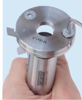
**2** Для фиксации свечи зажигания имеются резьбовые адаптеры различных размеров (M14, M18 или 7/8"). Адаптер может быть легко установлен или заменен с помощью винтов и шестигранного ключа.
