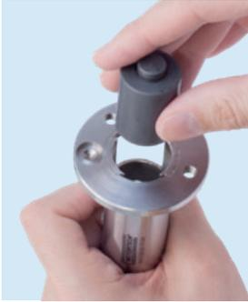
**1** Перед началом работы необходимо оснастить инструмент соответствующей пресс- вставкой (для каждого типа свечей зажигания соответственно).
