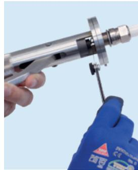
**4** Достаточно легкого нажатия рычага, чтобы отрегулировать зазор до желаемого уровня с помощью щупа между электродами.
