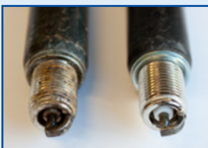
Zündkerze nach Gebrauch und nach der Reinigung
