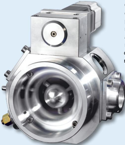
O VariFuel2 é um misturador de gás de alta tecnologia do tipo Venturi, podendo se adaptar continuamente às mudanças de combustível, permitindo ao motor trabalhar com eficiência máxima. As séries 100, 140, 200 e 250 são disponíveis para quase todos os motores. Acoplado a um controlador Lambda (mistura pobre ou estequiométrica), ele regula a mistura com precisão. É muito popular em aplicações de biogás, nas quais o valor calorífico do combustível pode mudar constantemente.
