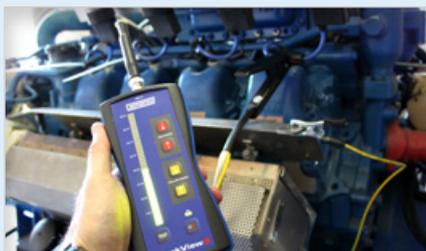
O novo testador portátil serve para monitorar a demanda de alta tensão da vela de ignição durante o funcionamento do motor. Com o cabo de medição e a exibição de até 40kV, é possível avaliar com facilidade o estado das velas de ignição e definir o momento ideal da troca.
