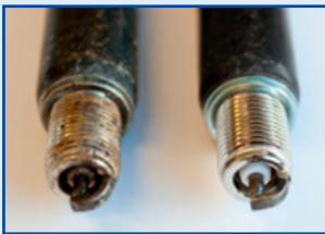
Zündkerze nach Gebrauch und nach der Reinigung
